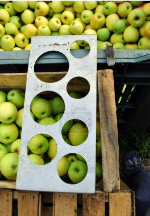
Ringkaliber: Die Schablone mit kreisrunden Löchern in verschiedenen Durchmessern ist eine einfache Methode, die Äpfel nach Größe zu sortieren.
