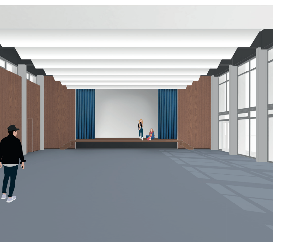
Aula im Mittelbau Die neue Akustikdecke nach bestehendem Vorbild integriert die neue Lüftung und Beleuchtung. Die Wandverkleidung wird aufgearbeitet.
